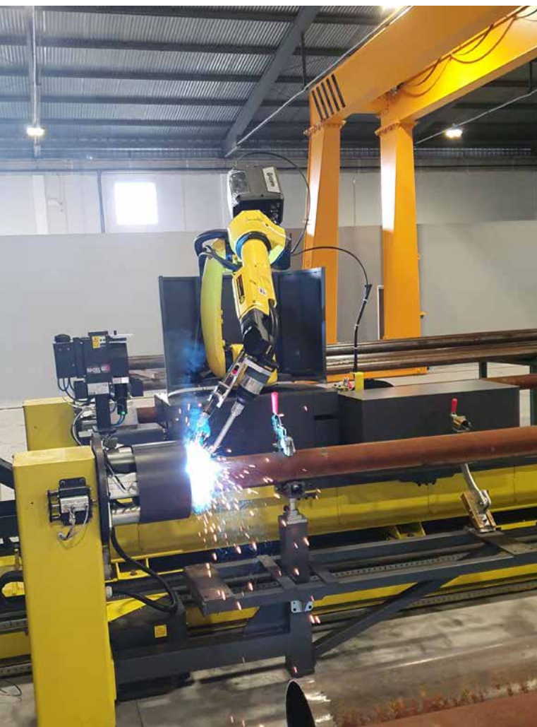
Robot de soldadura
